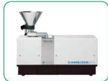
El equipo CAMSIZER X2 ha sido desarrollado para explotar la tecnología de cámara dual para la medición de polvos finos aglomerantes (0,8 µm a 8 mm). Con el fin de obtener resultados exactos para diferentes materiales, el CAMSIZER X2 brinda tres opciones de dispersión de partículas: X-Fall para dispersión por caída libre (similar al equipo CAMSIZER P4), X-Jet para dispersión por presión de aire y X-Flow para dispersión líquida.
