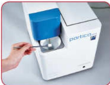
El analizador compacto de difracción por rayos láser Partica LA-350 es su herramienta de análisis de rutina. Puede lograr alto rendimiento con una operación y mantenimiento sencillos, sobresaliendo en aplicaciones tan diversas como química de lodos, minerales y papel. Es la combinación ideal de rendimiento, precio y empaque para agilizar el análisis de tamaño de partícula.
